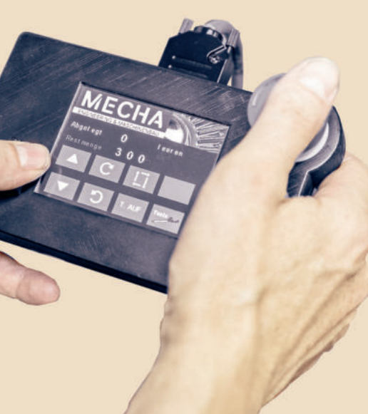
Pupitre opérateur avec commande Le pupitre avec écran tactile est indépendant de la machine d'usinage. Aucune interface avec la machine-outil n'est nécessaire. Un capteur détecte automatiquement les pièces introduites et mémorise les emplacements des containers occupés.
