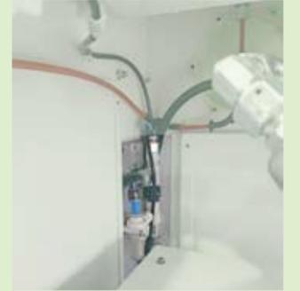
Générateur de vide monté à l'intérieur de la machine
