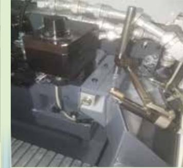
Tube flexible à l'intérieur de la machine, face à la contre-broche
