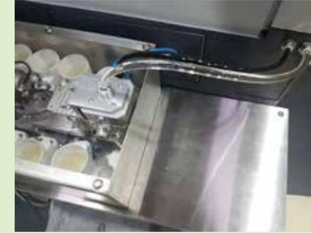
Tube flexible de DepotMini à l'intérieur de la machine
