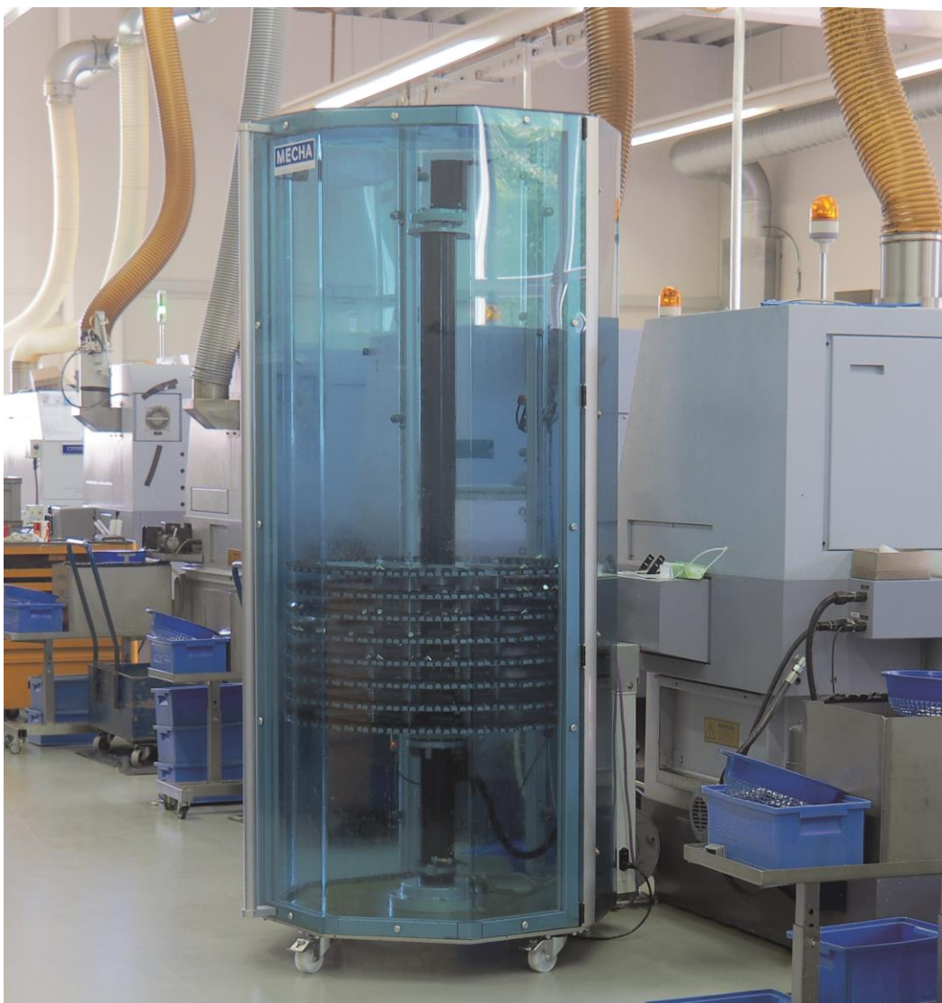
Abbildung 1: mit dem DepotMax in der Produktionshalle der Firma BB Zerspanungstechnik GmbH konnte der Ausschussanteil bei Glanzdrehteilen von 15% auf unter 2% reduziert werden.
