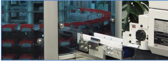
Abbildung 3: der Depotmax wird direkt an das Ausführband der Drehmaschine geschoben. Er benötigt keine elektrische Schnittstelle zur Drehmaschine
