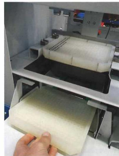
Bild 3: Der neue Palettenspeicher DepotPallet verfügt über zwei Paletten, die mittels Vakuumabsaugung befüllt werden können
